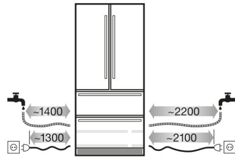
Conduit d'alimentation d'eau 3/4" nécessaire pour l'IceMaker automatique!
