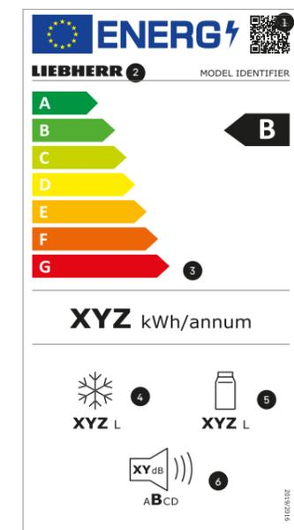
1. Code QR permettant d'identifier le produit dans la base de données européenne EPREL (European Product Database for Energy Labeling).
