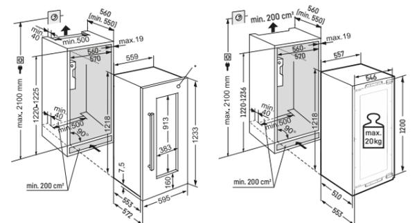
\* Schéma avec cadre en acier inox monté (accessoire).
