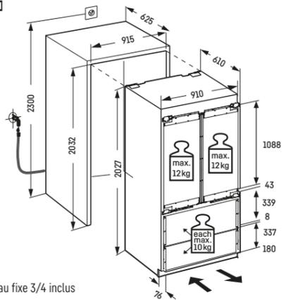
Tuyau 3m pour raccord d'eau fixe 3/4 inclus
