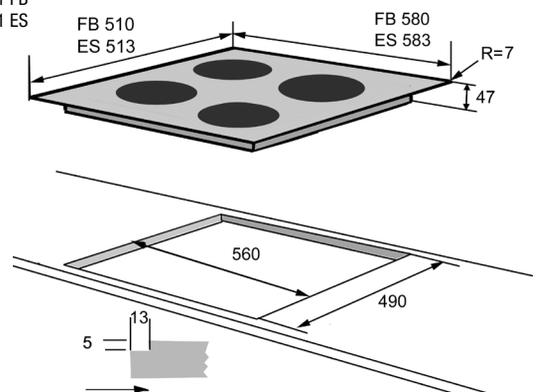
Ausfräsung/fraisage/fresatura 516 x 586 mm R = 10 mm
